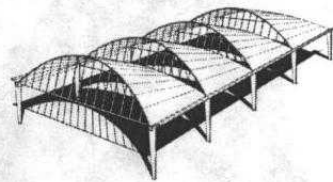
بام پوسته‌ای آزمایشی برای کارخانه‌ی راثول فرناندز، سن بارتولو، مکزیک، ۱۹۵۰ ترسیم پرسپکتیو
